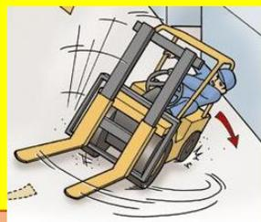
フォークリフトは様々な場所で使用されていますが、車体との接触や車体の横転・転落などにより、死亡など重大な事故が発生しています。法令には、作業場所の状況に応じた**作業計画の策定** ([安衛則第151条の3](#))、**就業制限** ([安衛法第61条](#))などが定められています。
